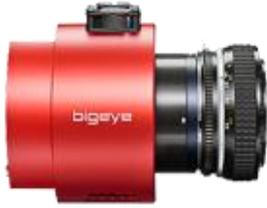
Bigeye G-1100B Cool 黑白工业相机是德国 AVT 公司生产的一款 1100 万像素高分辨率制冷工业相机，采用质量优越的低噪声 OnSemi KAI-11002 CCD 图像传感器，GigE 千兆网接口。可选配 Peltier 半体制冷，即使在曝光时间较长的情况下，也能获取高质量的图像。
